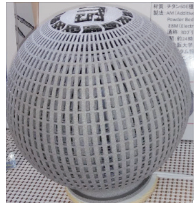
図 1 3D プリント製 複雑な構造の ランプシェード
