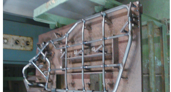
写真1 パイプ溶接用の治具
