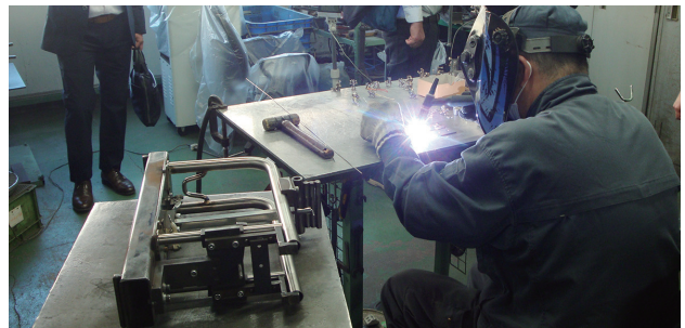
写真3 介護用補助走行機の手すりパイプ溶接作業
