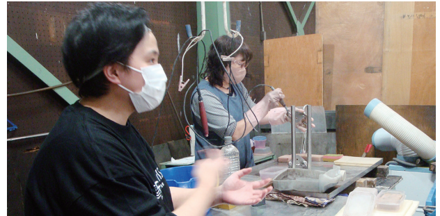
写真2 溶接後の変色を、電解法で除去する作業
